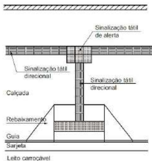
Figura 29 – Travessia de pedestres
