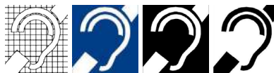
Figura 3 - SIA DEFICIÊNCIA AUDITIVA – Proporções / Branco sobre fundo azul / Branco sobre fundo preto / Preto sobre fundo branco
